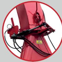
**Comando hidráulico**, permite que a bica do equipamento gire pelo comando no trator, facilitando a operação e proporcionando mais conforto ao operador.
