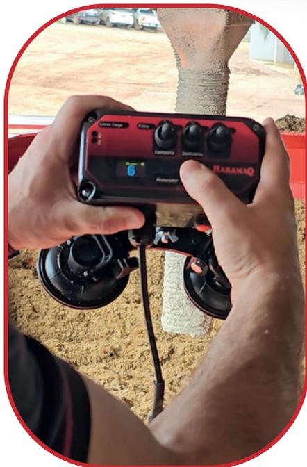
**Oito rotações no sistema de mistura,** permite ao operador ajustar a velocidade ideal para cada etapa do processo, desde a mistura até o descarregamento, com controle intuitivo via joystick ou aplicativo.
