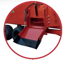
**Bica com abertura e ajuste hidráulico de altura,** permitindo a descarga de diversos tipos de alimentos em cochos de diferentes alturas.
