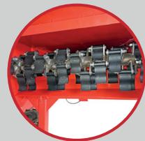
**Sistema exclusivo de rotor com 32 facas** fixadas individualmente por parafuso, facilitando a manutenção e evitando o emperramento das facas.
