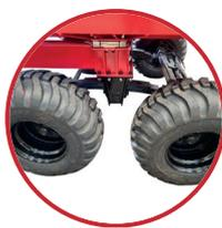
**Eixo traseiro extersante** (opcional) melhora o desempenho em terrenos irregulares, diminui a potência necessária reduzindo o consumo de combustível, menos desgaste dos pneus e facilita a manobra.
