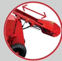
**Fresa com sistema de avanço,** facilita o posicionamento em relação ao silo, eliminando a necessidade de movimentar o trator a cada novo corte, assim aumenta a praticidade e eficiência durante o carregamento.
