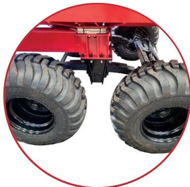
**Eixo traseiro extersante** (opcional) melhora o desempenho em terrenos irregulares, diminui a potência necessária reduzindo o consumo de combustível, menos desgaste dos pneus e facilita a manobra.
