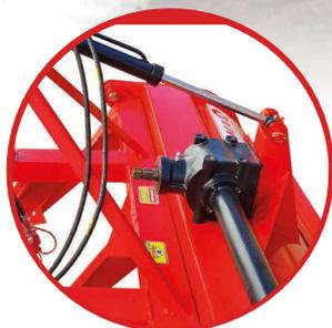
Regulagem hidráulica da rotativa, a qual facilita o ajuste da profundidade do subsolador, além de facilitar o trabalho em situações em que a rotativa esteja desligada.
