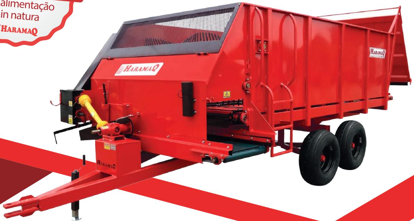
Percebendo a grande dificuldade na distribuição de fibras longas, a HaramaQ desenvolveu a **linha de vagões forrageiros VHF**, a qual transporta e distribui todos os tamanhos de fibras, de forma contínua e uniforme. A descarga pode ser lateral, direto nos comedouros ou então traseira, para produção de silagens.
