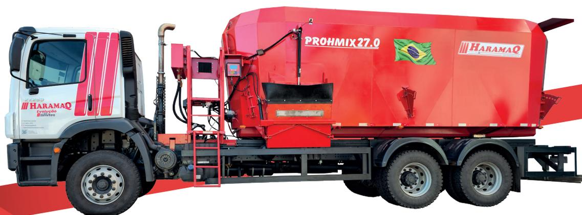
O Prohmix versão rodoviária destaca-se pela inovação em grandes propriedades, oferecendo ajuste de rotação dos rotores verticais para garantir **mistura precisa e descarga eficiente.**
